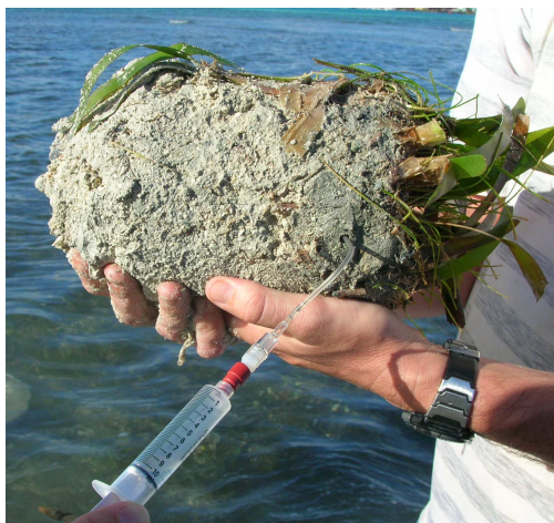
Figure 15 : Prélèvement d'eau interstitielle dans une carotte de sédiment d'herbier.
