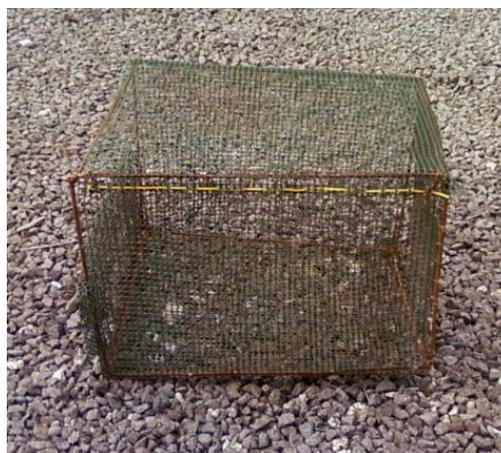
**Figure 46** : Photo d'un casier utilisé pour les expériences d'immersion de substrats végétaux.
